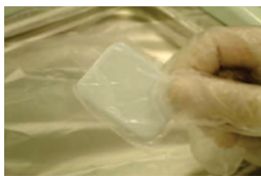
114: Filme radiográfico protegido por película de PVC.
